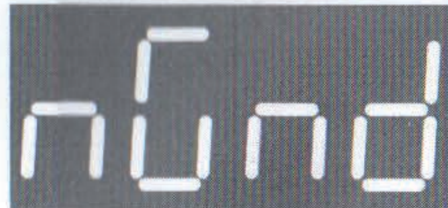
Работа без заземления
